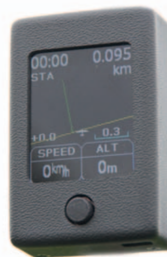
Das Empfangsgerät des T3000-Systems von RC Electronic ist relativ klein. Das scharfe Display ist auch bei Sonnenlicht gut ablesbar und zeigt alle relevanten Daten an
