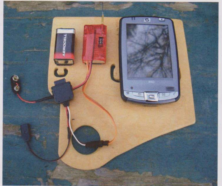
Bodenstation: 433-MHz-Datenempfänger und PDA mit SkyNavigator-Software.
